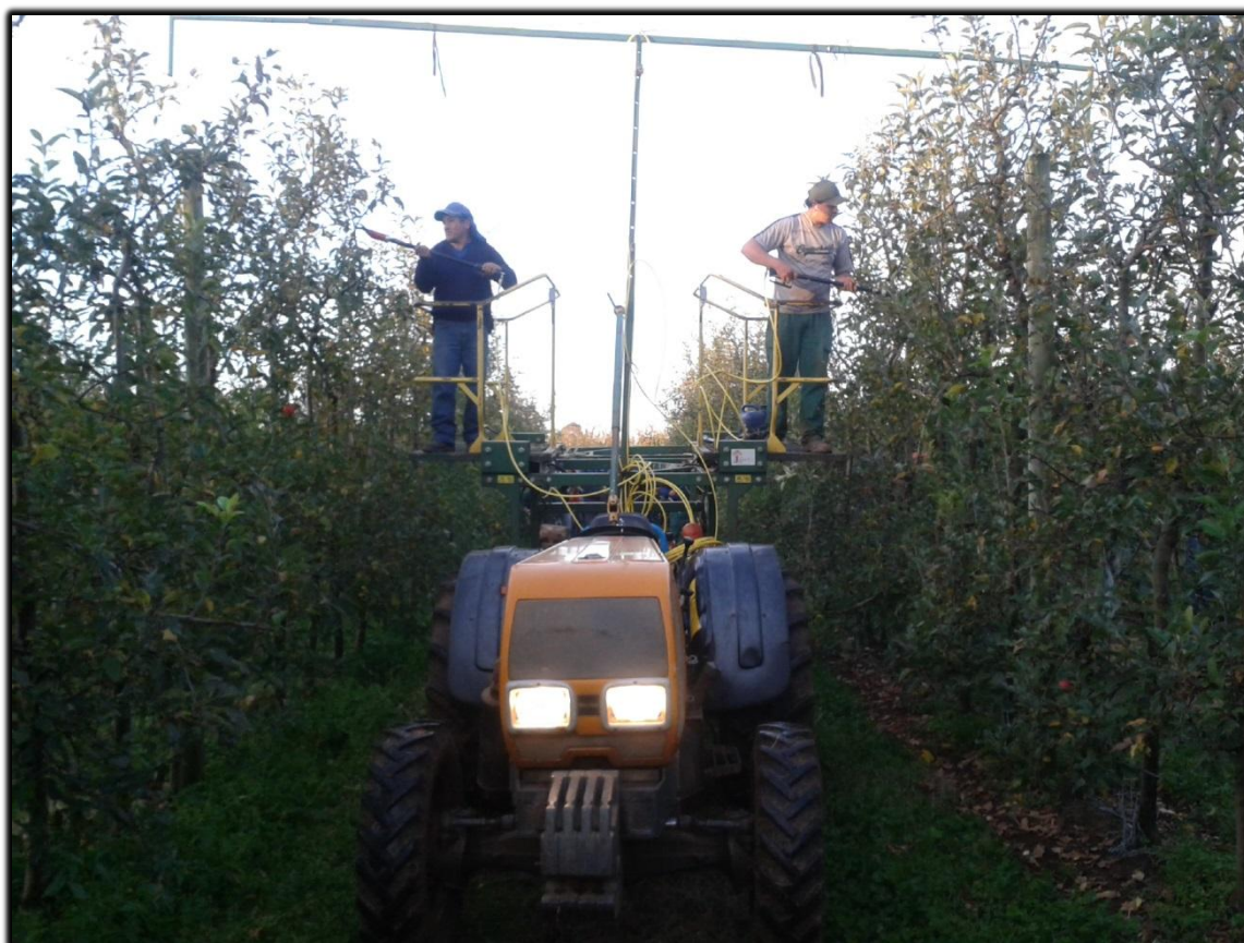
Figura 1- Poda com plataforma e tesouras pneumáticas. Detalhe no trator com tecnologia creeper, em que o tratorista pilota de cima da plataforma.
