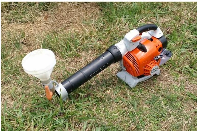
Figura 4. Soprador Stihl modelo BG86 C-E utilizado para a aplicação de iscas tóxicas onde a base é o atrativo Anamed®. Foto: Marcelo Z. Nunes.
