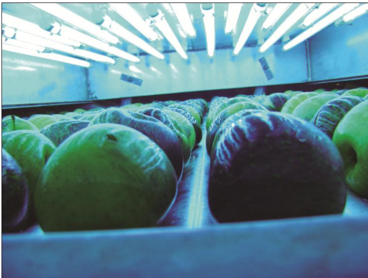
Foto 02: Maçãs sendo tratadas com radiação ultravioleta (UV-C).
